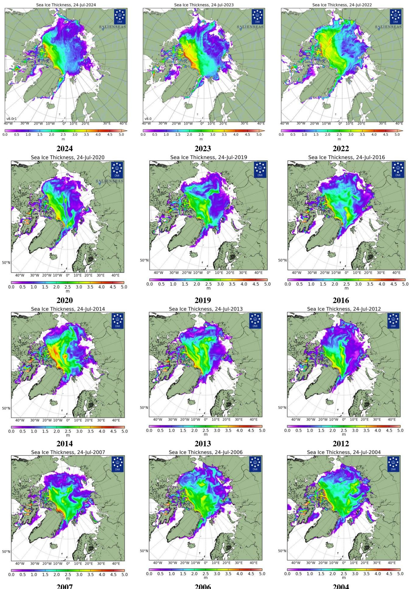
Рисунок 26 – Поля распределения средневзвешенной толщины льда совместной модели морского льда – океана HYCOM/CICE Датского метеорологического института 24.07 за 2004-2024 гг.
