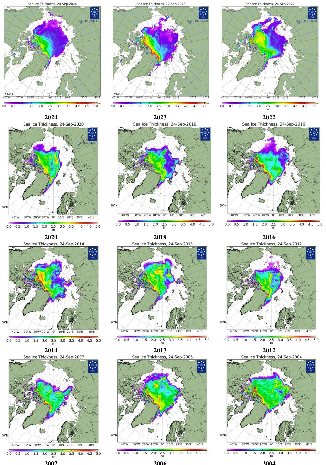
Рисунок 26 – Поля распределения средневзвешенной толщины льда совместной модели морского льда – океана HYCOM/CICE Датского метеорологического института 24.09 за 2004-2024 гг.
