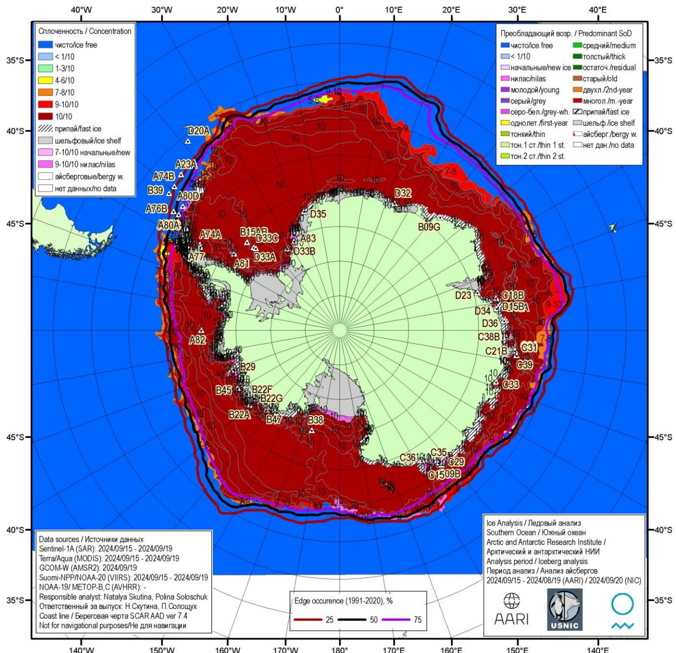
Рисунок 5а – Ледовая карта Южного океана (цветовая окраска по общей сплощенности) и расположение крупных айсбергов на основе ледового анализа за 19.09.2024 в рамках проекта совместного ледового картирования Южного океана ААНИИ, НЛЦ США и НМИ и повторяемость кромки за 16-20.09 за период 1991-2020 гг. по наблюдениям SSMR-SSM/I-SSMIS (алгоритм NASATEAM)
